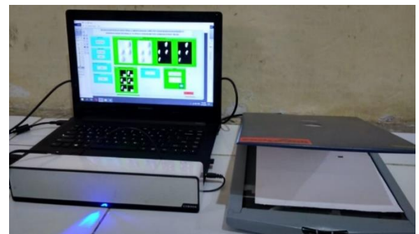
Gambar 14. Implementasi Identifikasi Huruf Braille Menjadi Sinyal Suara
