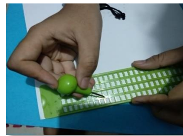
Gambar 4. Proses Pembuatan Sampel Huruf Braille dengan Reglet
