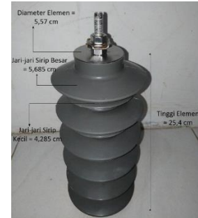
Gambar 1. ZnO arester dengan isolasi polimer
