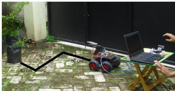
Gambar 6. Jalur pengujian gerakan robot
