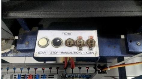
Gambar 2. Panel untuk mengoperasikan simulator sortir bola
