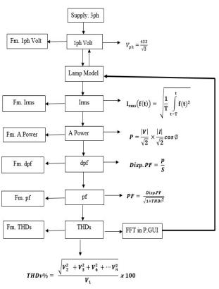
Fig. 8 Lamp model parameter tuning
