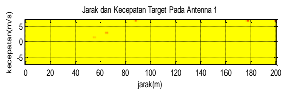
Gambar 4.9 Hasil simulasi matlab posisi target berdasarkan jarak-kecepatan
