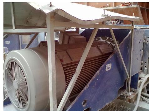
Gambar 9. Motor induksi ukuran besar pada mobile crusher
