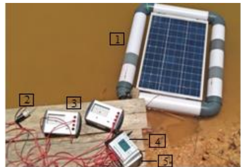
Gambar 4. Purwarupa sistem aerasi bertenaga sel surya apung
